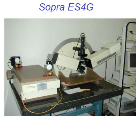
Figura 3.11: Caratteristiche dell'ellissometro a polarizzatore rotante SOPRA ES4G.
